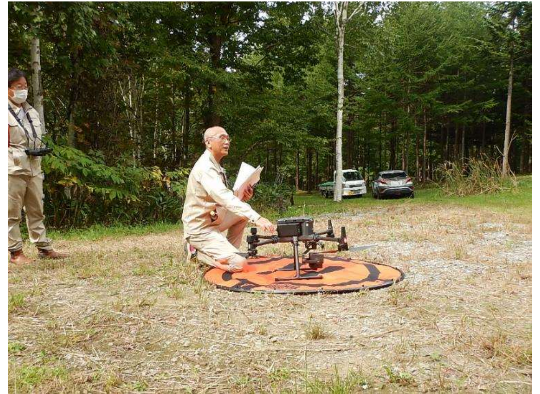
[L i D A R搭載UAV調査手法の実演] (講師：石狩市森林組合)
