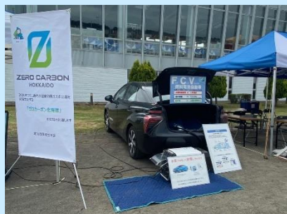
▲ 音響機材や電気機器へFCVから水素エネルギーを供給しました
