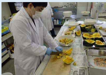
①前処理(燃烧しやすく粉砕し計量)
