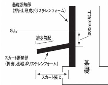
凍上現象のひどい地域の畜舎や堆肥舎でも、数力所の実験・検証の結果より、断熱材の地中埋め込み深さ200 mm以上、スカート幅600 mm程度のスカート断熱工法を採用することで、凍結深度の緩和が可能で、安価となります。
