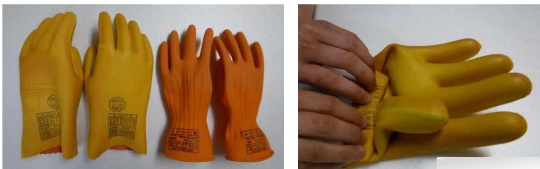
左：絶縁用保護具・防具類の耐電圧試験方法準拠の手袋 右：手袋を捲いて空気をため込み損傷を確認する方法
