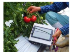
光センサーを用いた非破壊診断によるトマトの適正施肥
