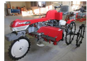
水稲有機栽培の除草時間を低減する駆動式除草機
