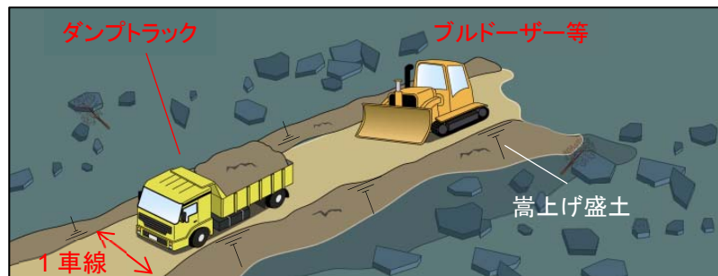
図 16 浸水対策班の作業イメージ
