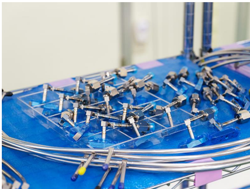
半導体製造装置の精密配管
