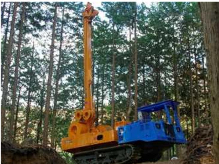
○スウィングヤーダ（旋回ブーム式タワー付き集材機）
