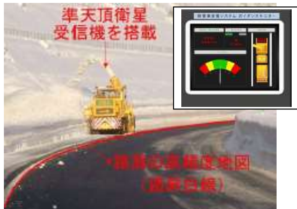
NEXCO 東日本は衛星測位による除雪機の運転ガイダンスを開発
