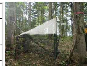
昆虫捕捉装置 (マレーストラップ)
