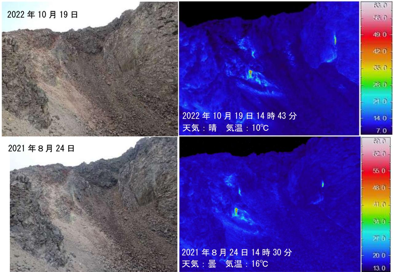
図7 アトサヌプリ 赤外熱映像装置による熊落し火口の地表面温度分布
