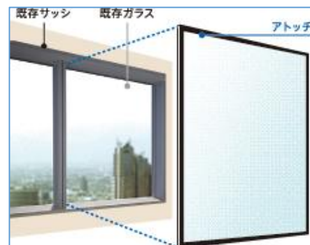
アトッチの施工方法
