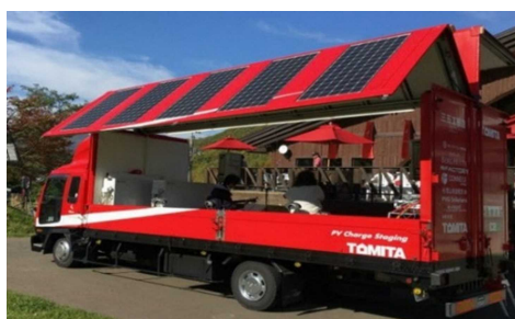
PVチャージステージング 1.2kwの太陽光パネル設置 ウィング可動により集光率アップ
