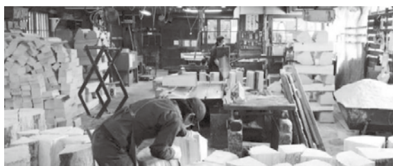
エゾマツを原材料とする経木の製造
