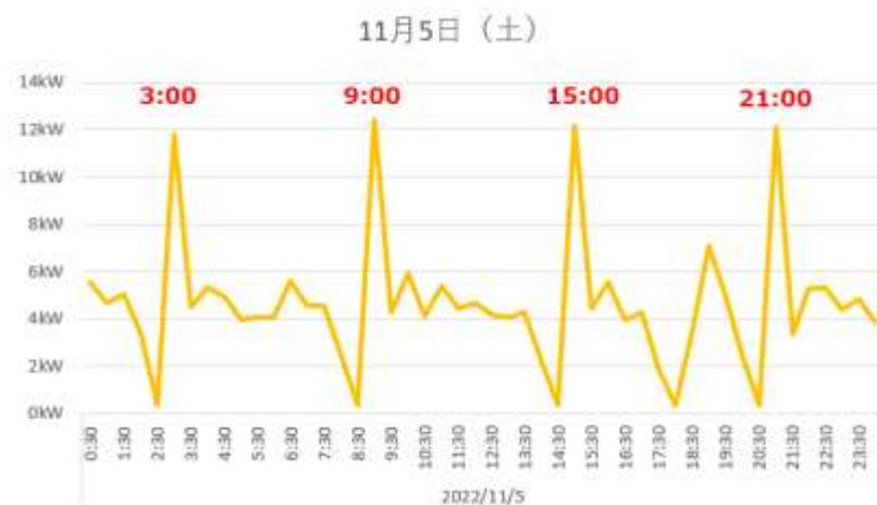
図-IV.2.13 現地冷凍庫の消費電力状況
