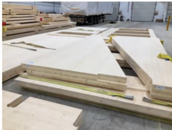
プレカット後。このままトレーラーで搬出
