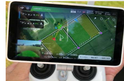
自動走行中の制御モニター ・圃場を2分割し、2機のドローンが飛行する
