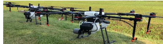
実証で使用した2機の液体散布ドローン ・1回の飛行で1 ha分の農薬を散布できる
