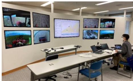
複数圃場に4台配置したスマート農機の遠隔監視制御
