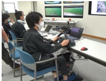
農道走行（無人）時に遠隔操縦により障害物を回避する様子
