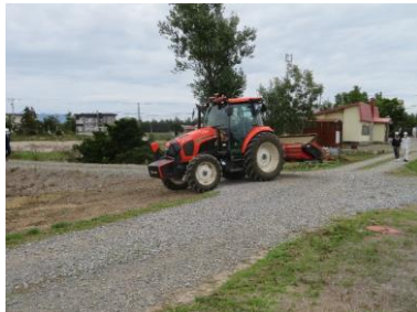
農道を走行して圃場内作業へ向かう無人ロボットトラクター
