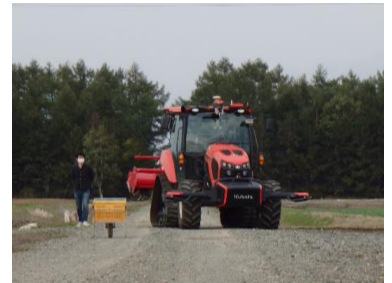
農道走行（無人）時に遠隔操縦により障害物を回避する様子
