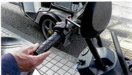
アクセルを戻すだけで自動回生ブレーキが作動
