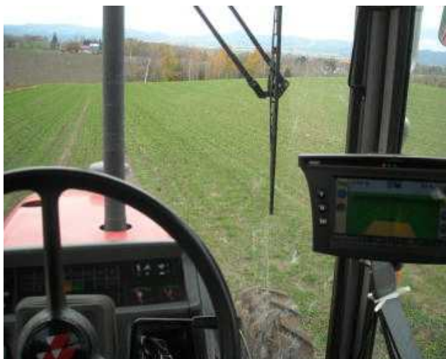
トラクターの運転席に取り付けられた本機モニター GPS ガイダンスを活用した防除風景
