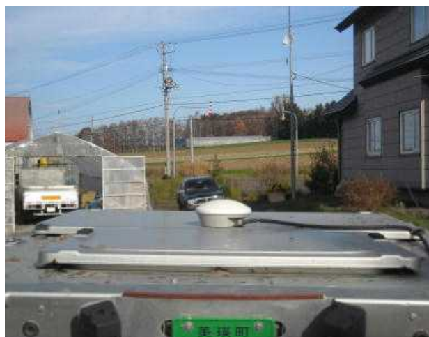
トラクターの屋根に取り付けられたアンテナ
