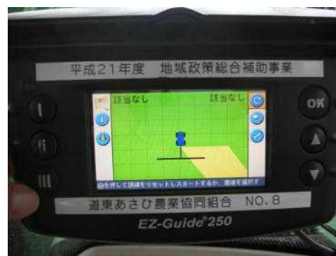
写真1 GPSガイダンスシステム（本体） ニコン・トリンプル EZ-Guide 250
