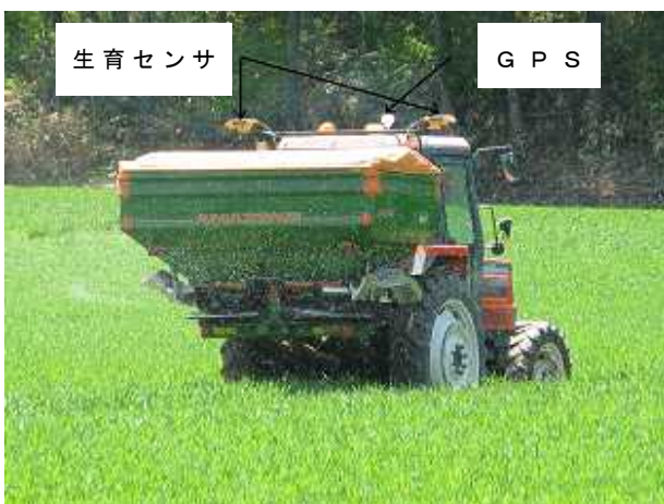
写真4 センシング後の可変施肥作業
