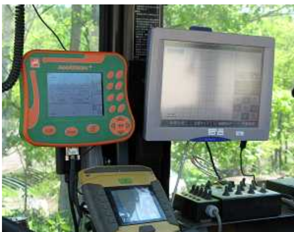
写真3 トラクタ内の制御システム
