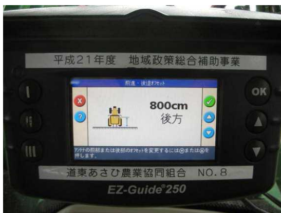
写真4 アンテナと作業機のオフセット値設定画面
