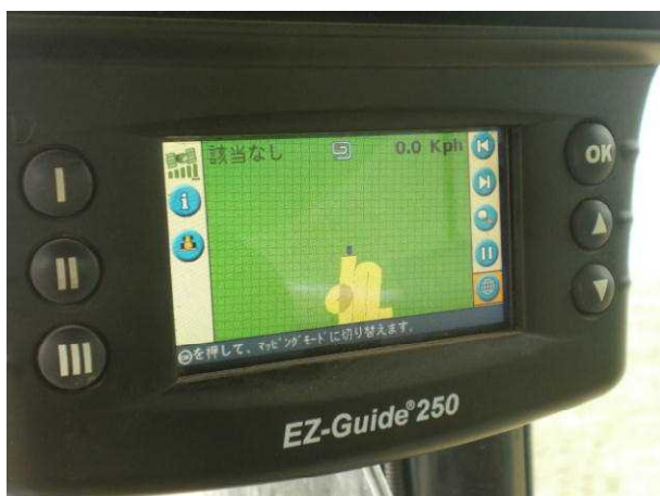
写真3 GPSガイダンスのモニター
