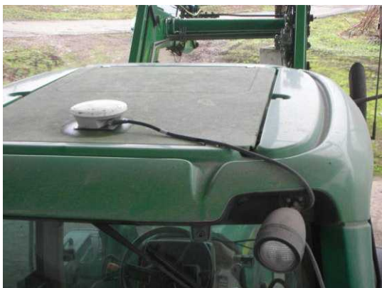
写真2 GPSガイダンスシステム(アンテナ)
