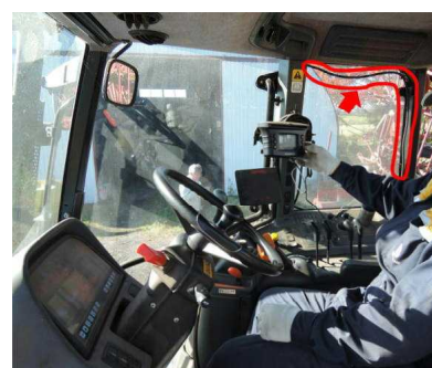
本機キャブ内における設置の様子 矢印で示す枠内に配線
