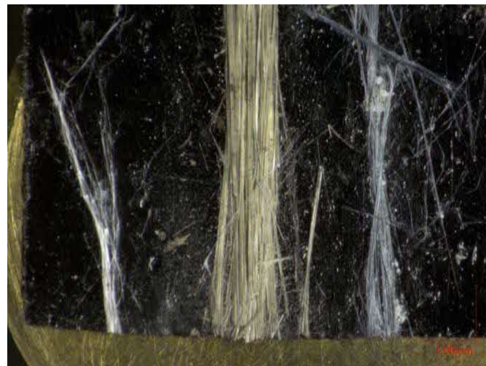
アスベスト特有の形態的特徴 (倍率40倍)
