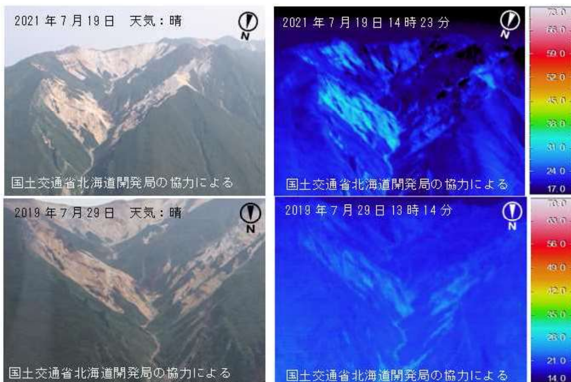
図5 知床硫黄山 赤外熱映像装置による東岳大火口の地表面温度分布 上段：北側上空(図1の⑤)から撮影 下段：北側上空(図1の⑥)から撮影 ・前回(2019年7月)の観測と比べて、特段の変化は認められませんでした(一部領域で周囲に比べて温度が高く見えるのは日射による影響と考えられます)。
