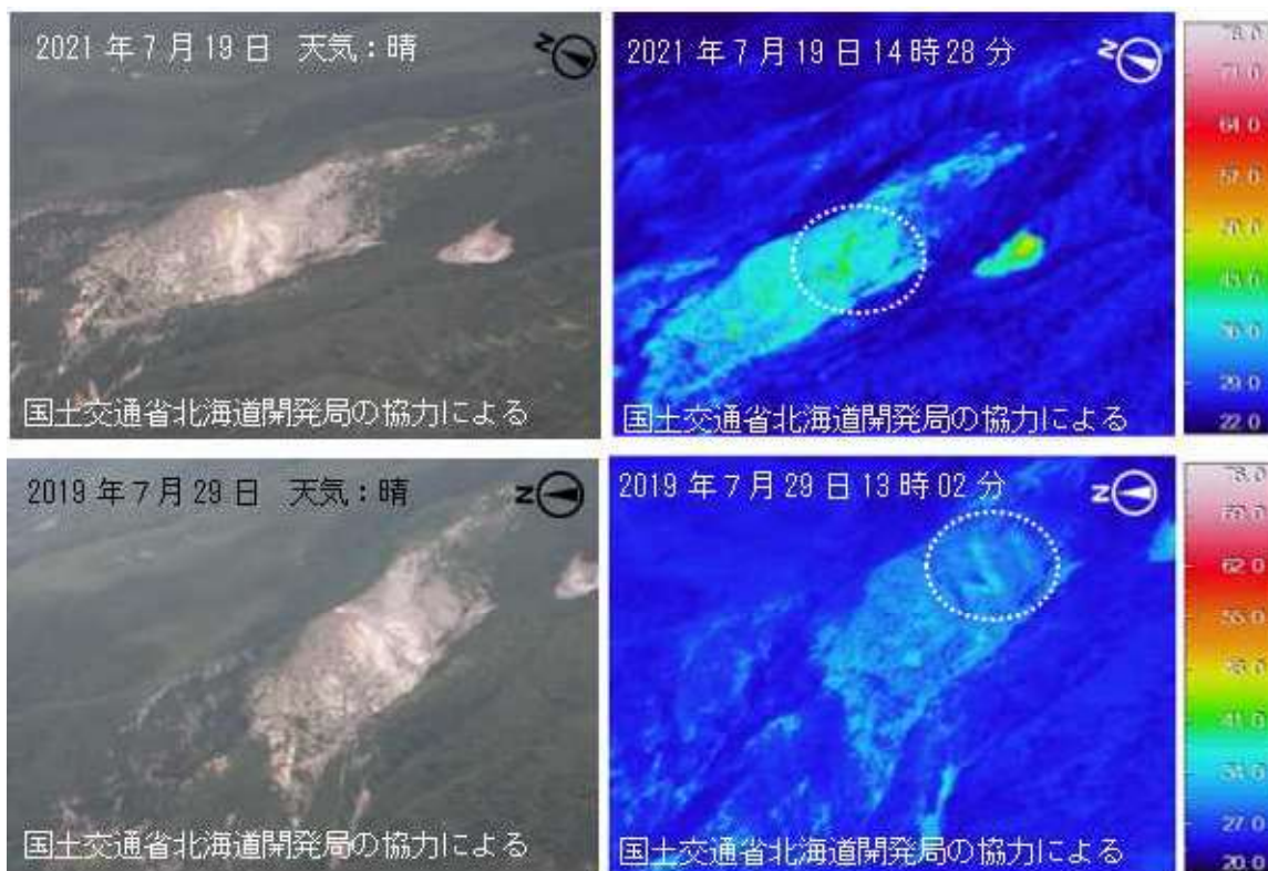
図4 知床硫黄山 赤外熱映像装置による北西側中腹の爆裂火口の地表面温度分布 上段：西側上空(図1の③)から撮影 下段：西側上空(図1の④)から撮影 ・前回(2019年7月)の観測と比べて、弱い地熱域(点線で囲まれた領域)の地表面温度分布には特段の変化は認められませんでした。
