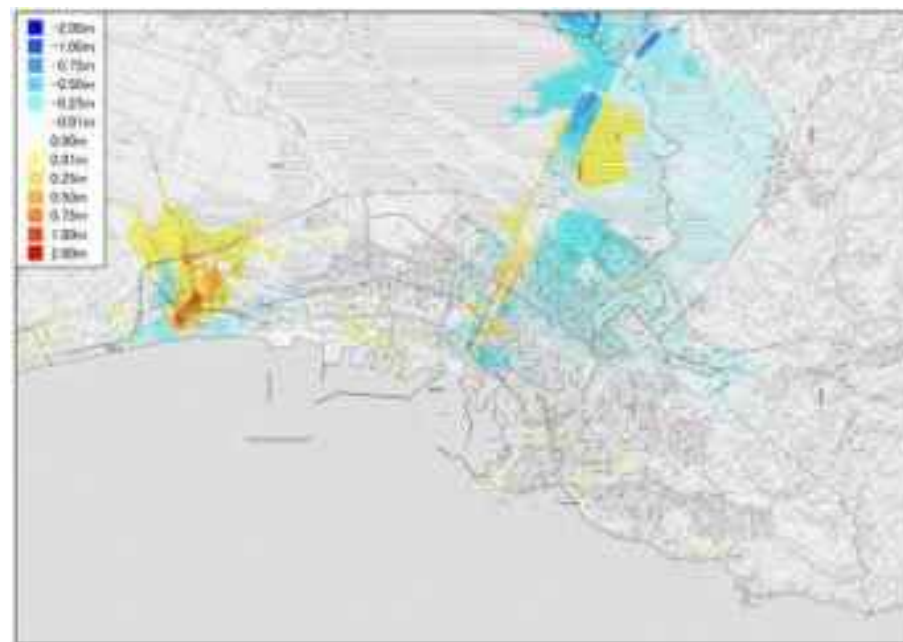
ケース⑤：地震動による防波堤等構造物破壊・河川堤防75%沈下・越流時破壊有り
