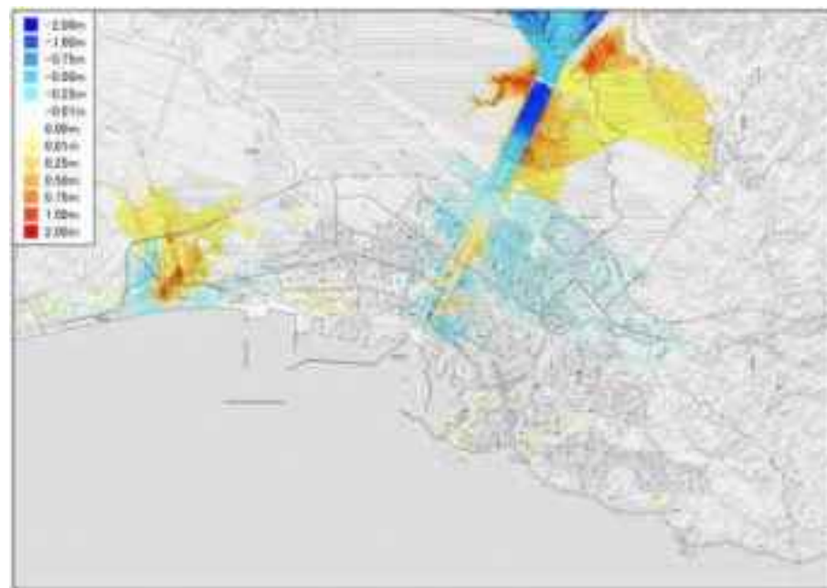
ケース④：地震動による防波堤等構造物破壊・河川堤防50%沈下・越流時破壊有り
