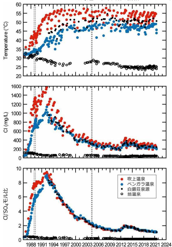
図 2-5 十勝岳周辺の温泉の温度(上)、Cl 濃度(中)、Cl/SO<sub>4</sub> モル比(下)の変化(～2021年6月)。
