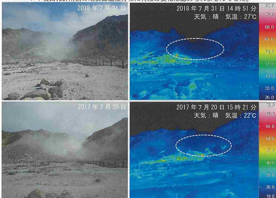
図7 アトサヌプリ 赤外熱映像装置によるF1噴気孔群北側の地表面温度分布 北側(図3の③)から撮影
