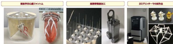
核医学用心臓ファントム 北海道科学大学・大野記念病院との共同開発です(特許出願中)。 CTやPET検査装置の画像を標準化する為に、心臓臓器内臓モデルに 心臓ファントムを用いて、画像画像の管理を公正に行っています。
