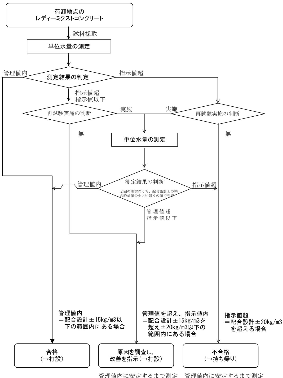
レディーミクストコンクリートの単位水量測定の管理図 (kg/m<sup>3</sup>)
