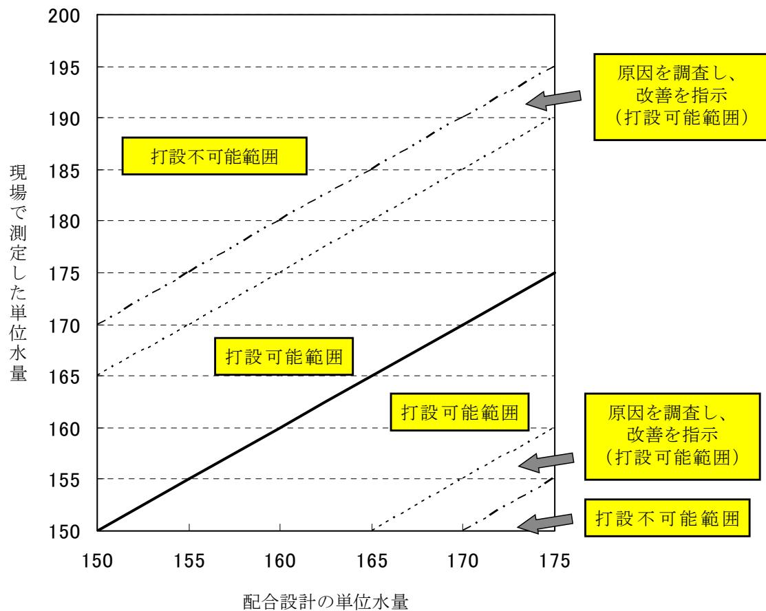
注) 単位水量の上限値が175kg/m<sup>3</sup>の場合 (粗骨材最大寸法が20, 25mm)
