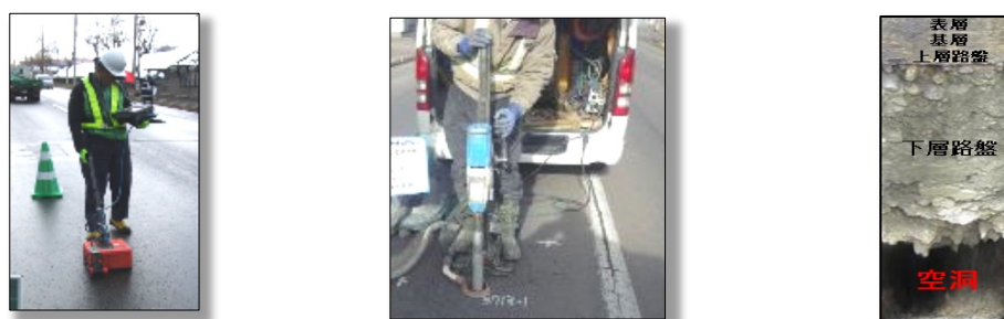
写真 2-2 二次調査 ハンディ型の地中レーダ・スコープ調査と空洞の例
