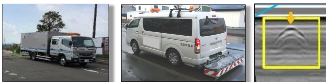
写真 2-1 一次調査の探査車と異常信号の例
