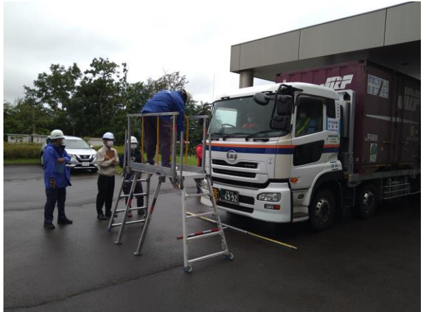
写真4：運搬車両の空間線量率測定状況
