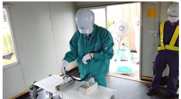
写真6：表面汚染密度測定状況（安定器）
