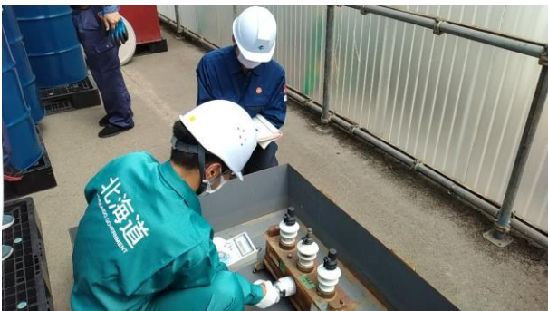
写真5：表面汚染密度測定状況（コンデンサ）
