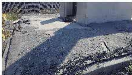
第4図 苫小牧東港における噴砂。 Fig. 4 Liquefied sand boil at the Tomakomai east port.
