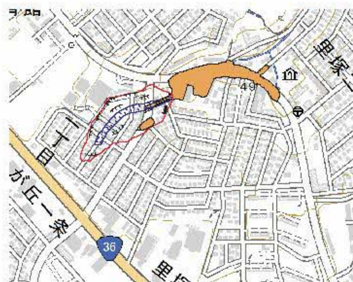
第18図 里塚北西部(1条1丁目~2丁目)の地表変動分布。赤線内は開口亀裂をはじめ地表変動が発生した範囲。青線は凹地状の地盤陥没が生じた範囲、オレンジ色で示した部分は土砂が堆積した範囲を示す(背景地図は、国土院の地理院地図)。
