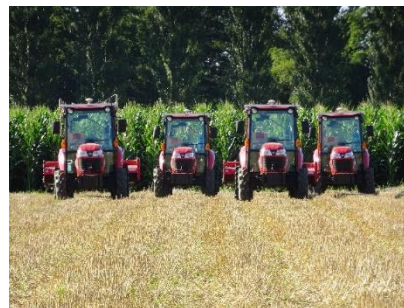
衛星測位による無人トラクタの協調運転 (北海道大学 野口伸教授資料)
