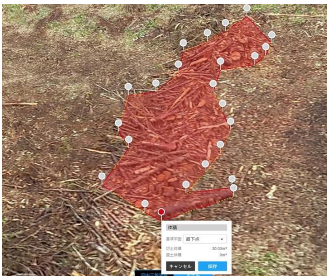
図 63 厚岸町有林における林地未利用材の体積推定 (図中の「切土体積」が林地未利用材の推定体積)
