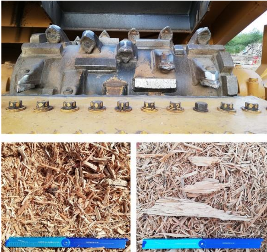
図 34 破碎ドラム（上段）と製造したチップ（下段左：通常の形状、下段右：オーバーサイズ）
