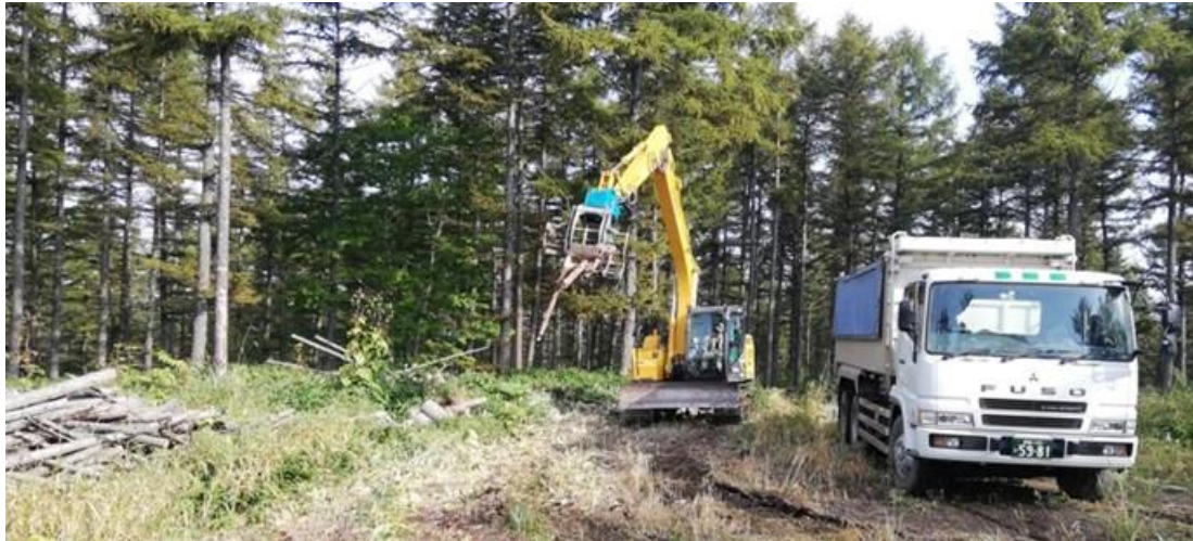
図 26 林地未利用材の集荷作業
