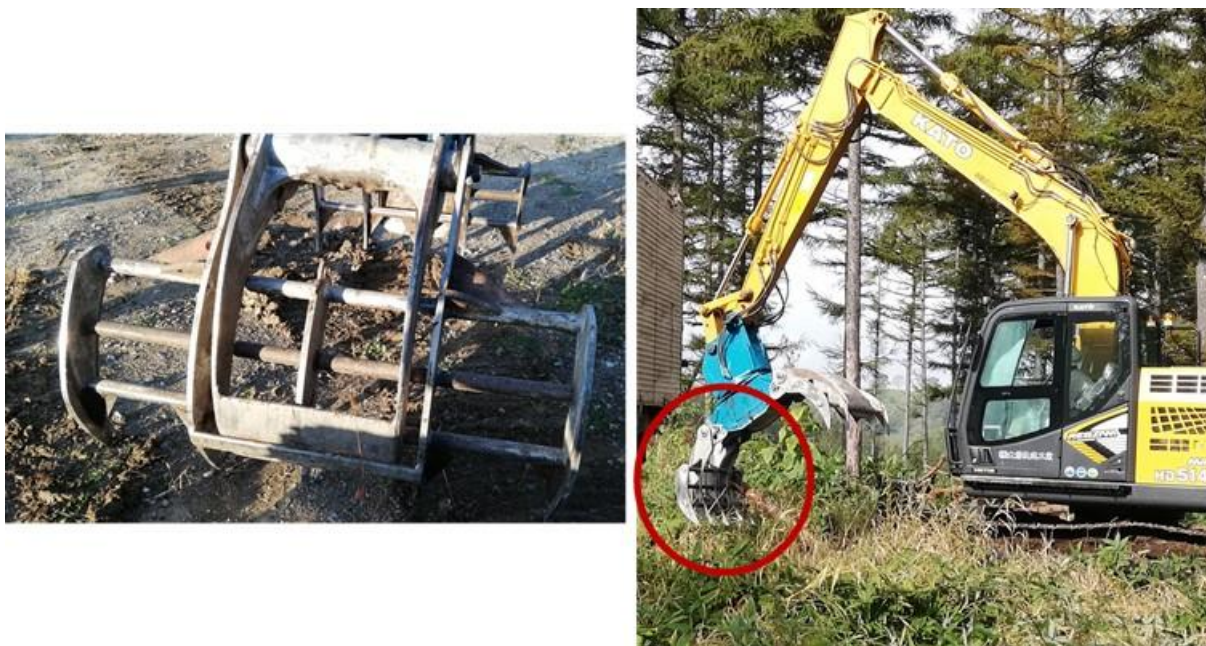
図 29 使用したグラップルレーキ（左）と林地未利用材が挟まった様子（右）
