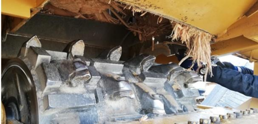
図 35 チッパー内部の点検
