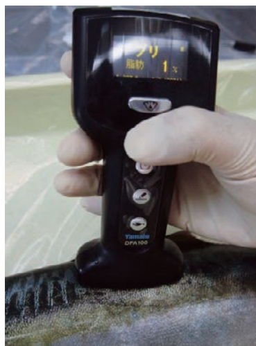
写真2 フィッシュアナライザによる測定
