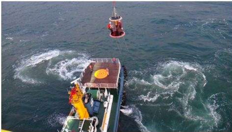
サプライボートとバスケットによる作業員吊移動
