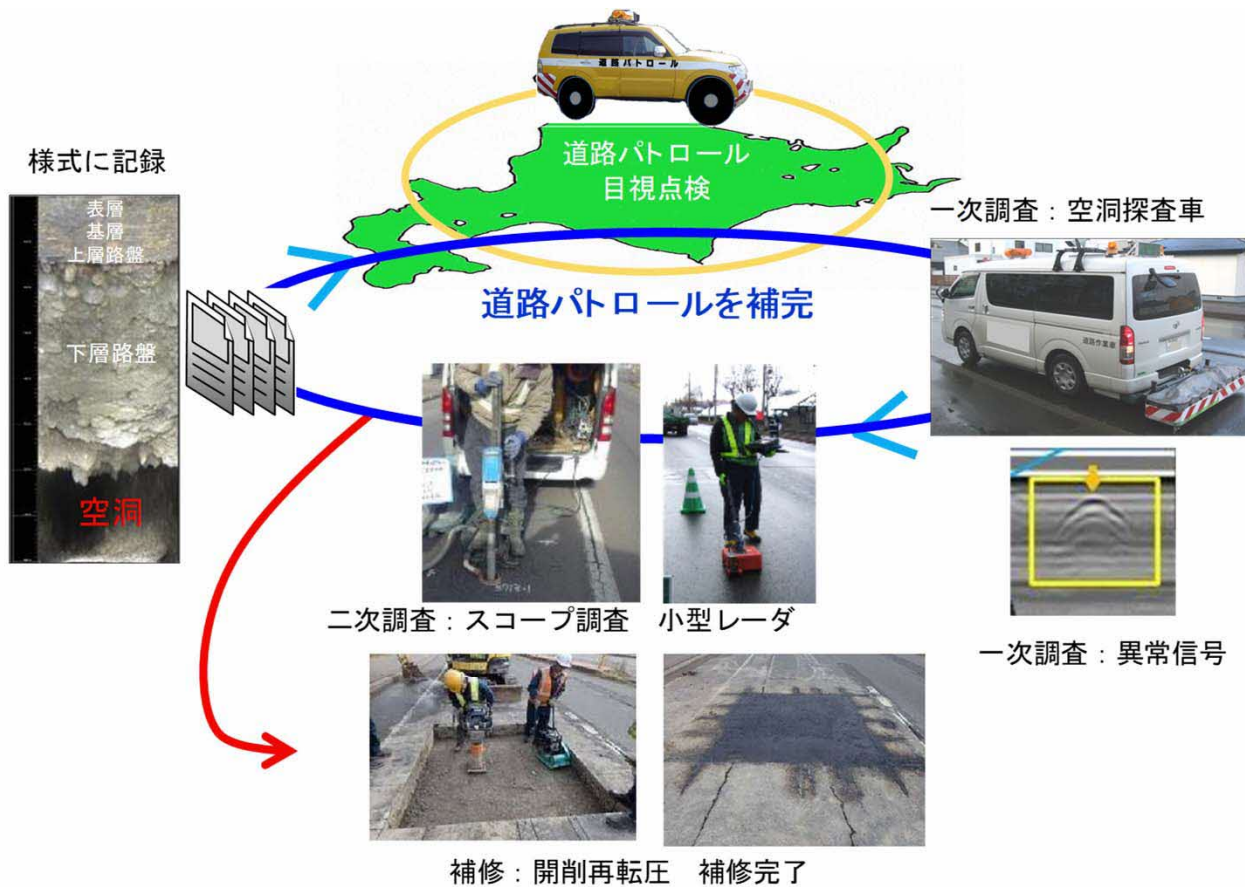
路面下空洞調査の作業模式図
