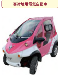
次世代モビリティ用のミニカー規格に沿った、寒冷地向け一人乗り電気自動車
