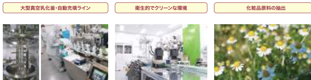
大型の真空乳化釜は一度に300kgの製造が可能。正確で効率的な自動充填ライン。他に100kgの真空乳化釜も保有しており、小ロットにも対応が可能です。 化粧品はお客様の肌に触れるもの。衛生面にも配慮し、クリーンな環境で製造を行っています。 化粧品にこだわれば、必ず原料に行き着きます。植物や動物由来のエキス抽出も行っています。地元素材の活用などの相談も承ります。
