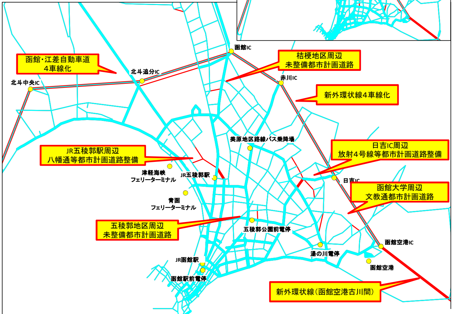
図 将来令和22年(2040年)道路網図(整備区間)
