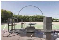
風雨にさらされる電子部品や、水を使う食品加工機械などの防水性を評価
