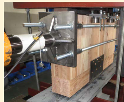
【接合性能試験】
