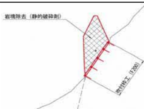
従来工法(人力法切+法枠工)
