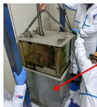
装置内のコンデンサーの確認作業の様子
