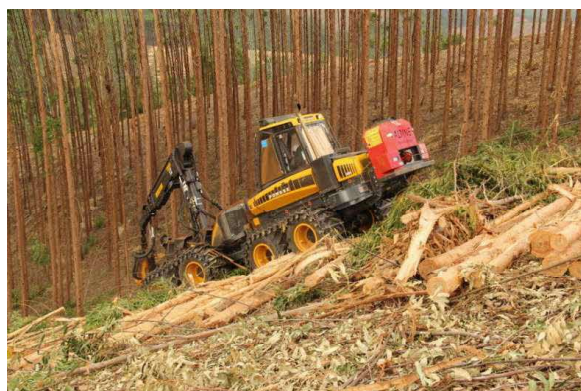
ケーブルアシストにより急傾斜で伐倒作業を行う 林業専用機
