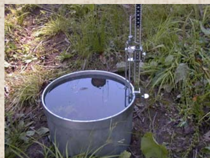
浸透能の計測状況 (シリンダーインテーク法)
