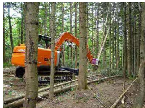
かかり木を重機で処理している様子
